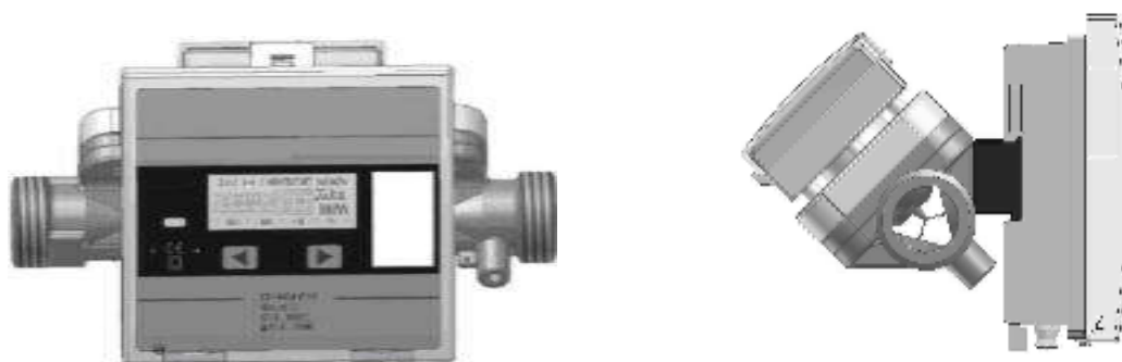
Рис.Д5. Установка вычислителя в щите
