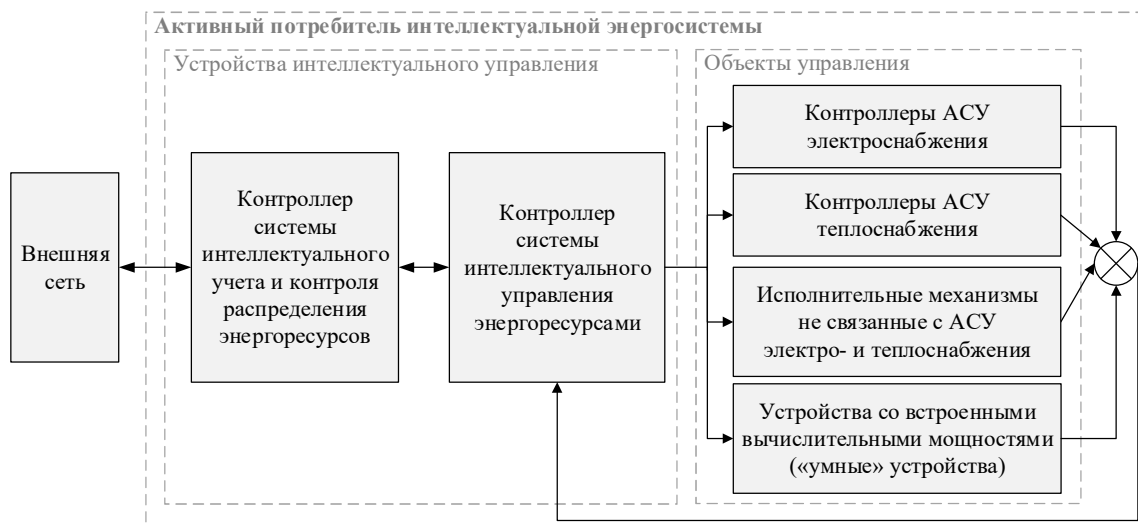
Рисунок 2 – Обобщенная структурная схема автоматизации потребителей ИЭС
